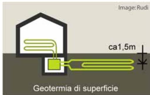
Le pompe di calore geotermiche di profondità sfruttano il fatto che all'aumentare della profondità, il sottosuolo ha una temperatura costante, mentre la geotermia di superficie risente di più dell'irraggiamento solare
